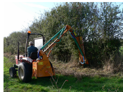
Taille mécanisée au lamier
